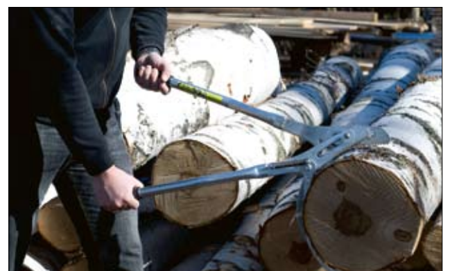
Opatentowany obracak pomaga w przetaczaniu kłód.
