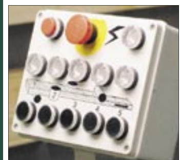
Każdy z pięciu silników uruchamiany oddzielnie.
