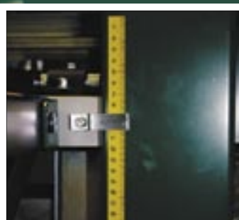
Łatwe ustawianie. Podziałka wyskalowana co 0.1 mm.
