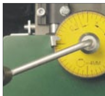
Łatwe ustawianie. Podziałka wyskalowana co 0.1 mm.
